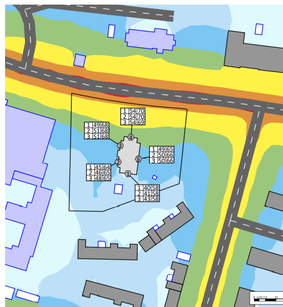
Bild 7: Beräknade trafikbullernivåer vid fasad, nuläge. Tabellerade värden är frifältsvärden och avläses "Våning / Leq / Lmax".
