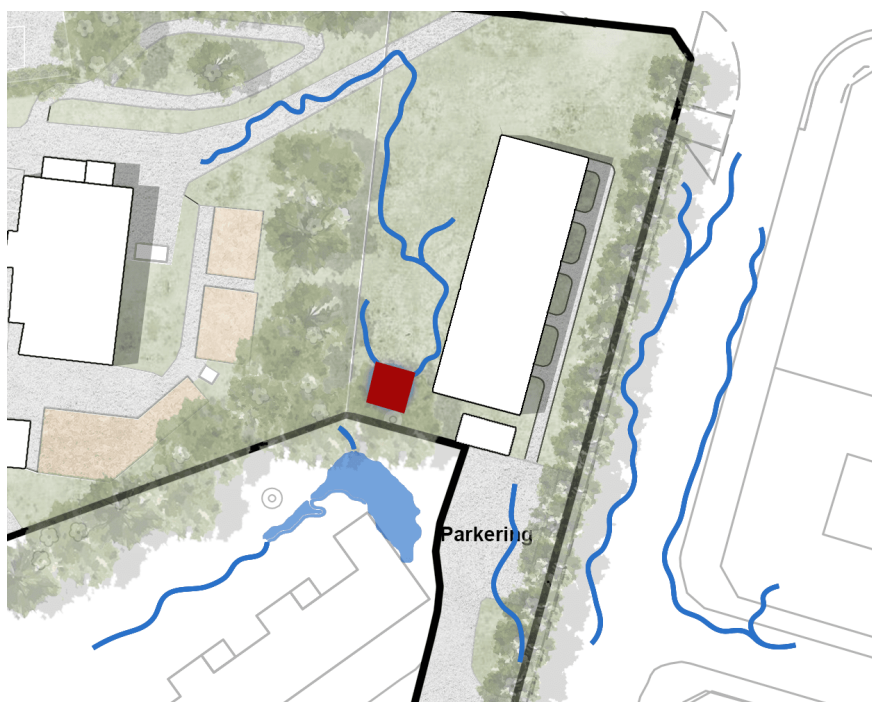
Figur 6: Förslag till placering av fördröjningsmagasin. Blå linjer visar avrinningsstråk.
