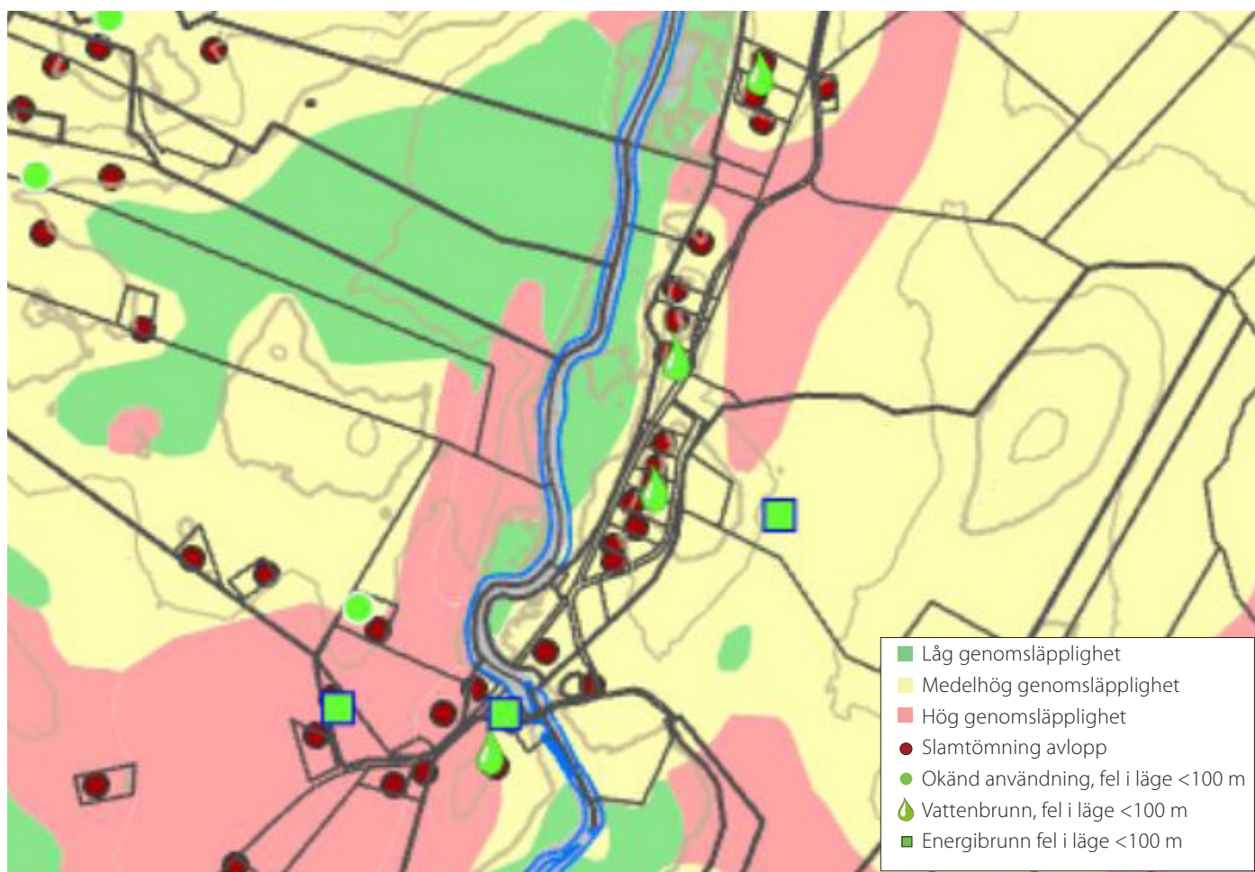
Figur 21. En förenklad bild över markens genomsläpplighet, avloppsanordning som töms av kommunen, samt vatten och energibrunnar från SGU:s brunnarkiv.
